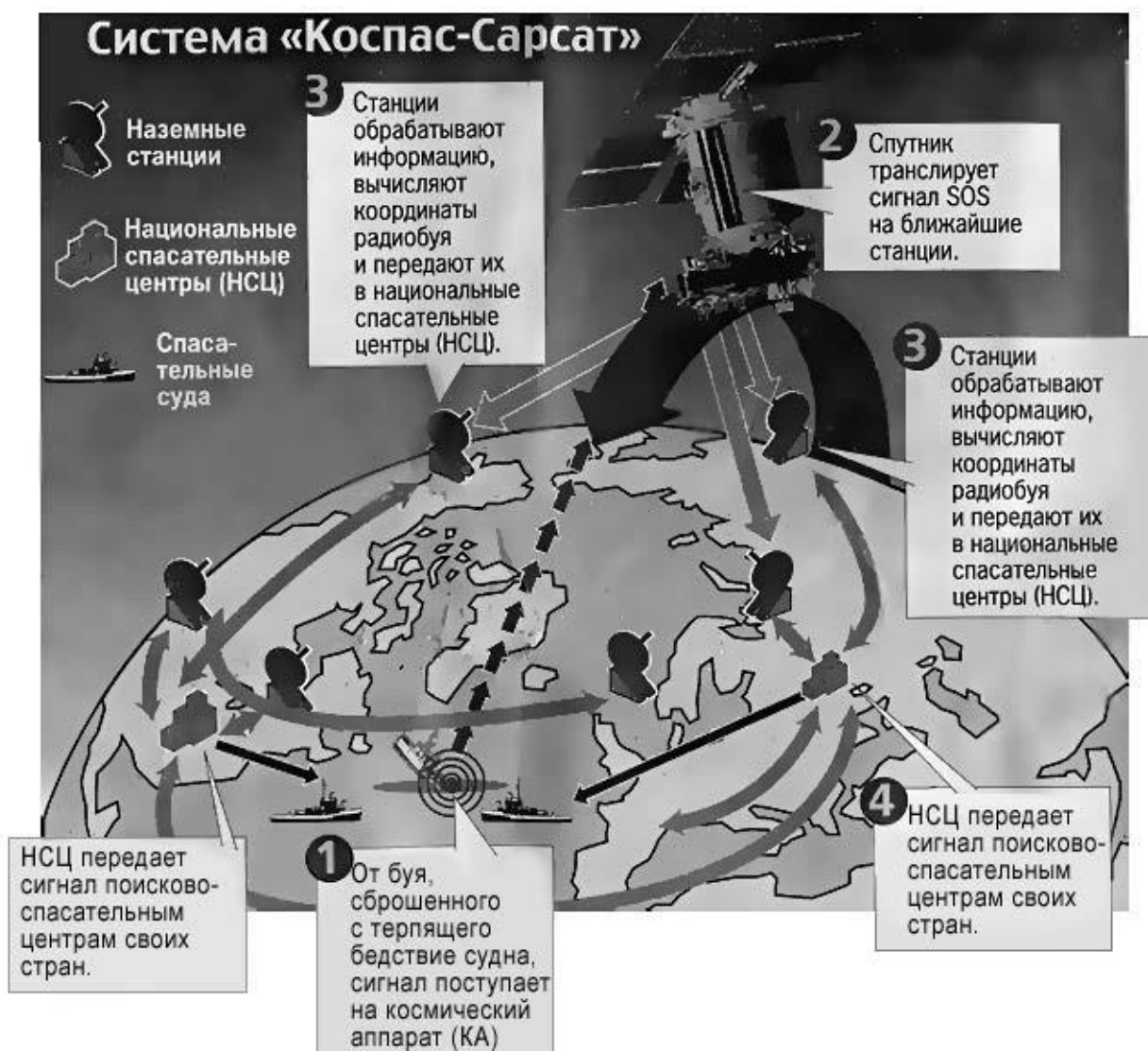
Рис. 1.30. Принципиальная схема системы КОСПАС-САРСАТ
