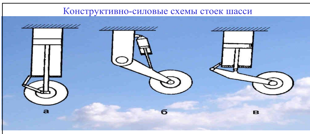
Рис. 4. Типы стоек: а – телескопическая; б – рычажная; в – полурычажная
