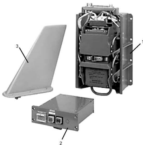
Рис. 1.33. Устройство АРМ-406 П: 1 – моноблок, 2 – пульт дистанционного управления, 3 – внешняя антенна АНТ-406В
