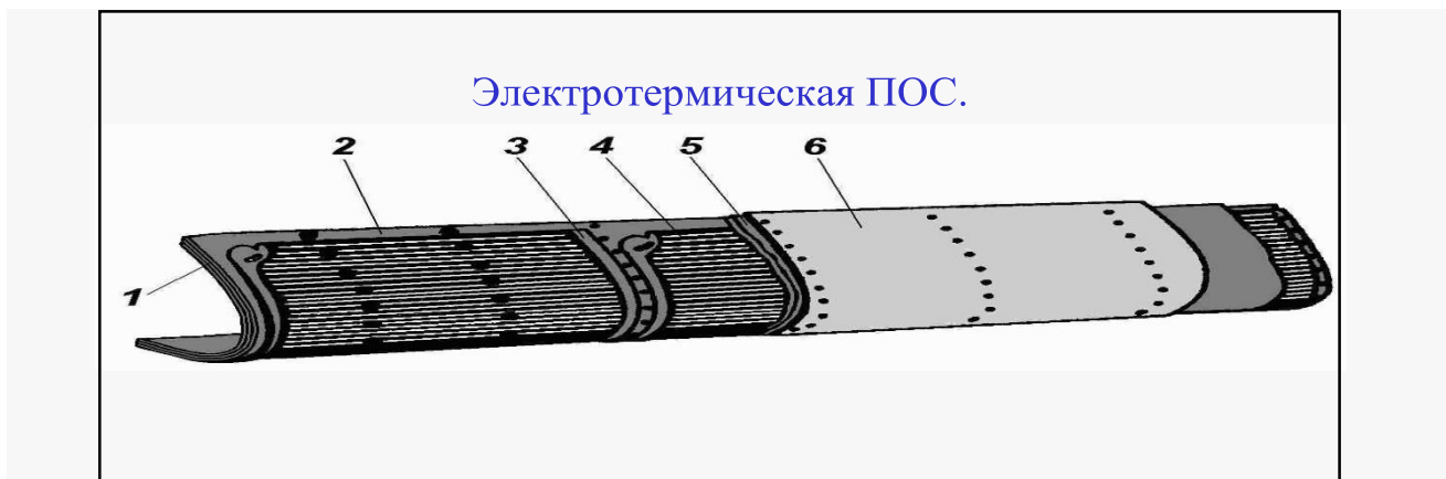
Рис.2. Конструкция электронагревательного элемента передних кромок крыла: I - внутренняя обшивка 2,4,6 - стеклоизоляция; 3 - нагревательный элемент; 5 - тепловой нож; 7 - внешняя обшивка
