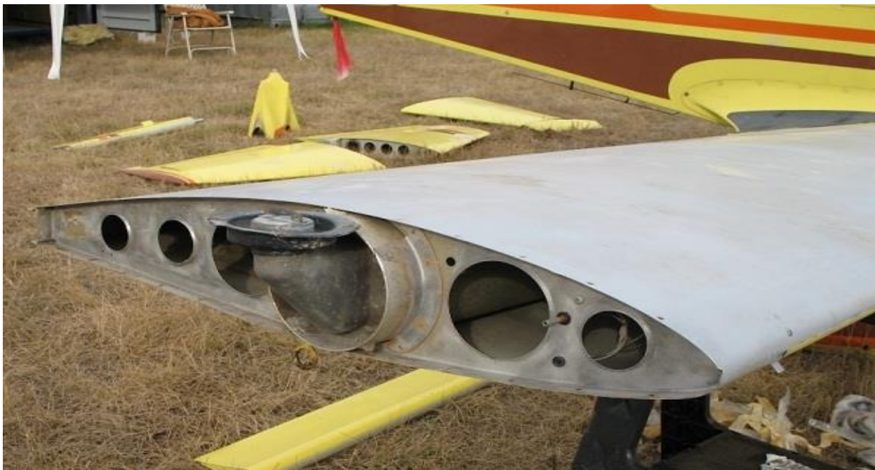
Рис.11. Топливный бак в лонжероне
